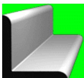
直角度 / Squareness  $90^\circ \pm 2^\circ$ 曲がり / Straightness 長さ1mにつき3mm以下とし、全長に対しては、 $3\text{mm} \times \text{長さ(m)} \div 1\text{m}$ 以下とする。Not more than 3mm per 1m, Not more than  $3\text{mm} \times \text{Length(m)} / 1\text{m}$  per Total Length.
